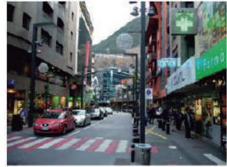
En esta imagen podemos observar una solución de vía de plataforma única en la que el espacio de los peatones y el del tráfico rodado está a la misma cota. En este caso, si bien se ha protegido la circulación mediante el uso de bolardos el acabado del pavimento es el mismo.
