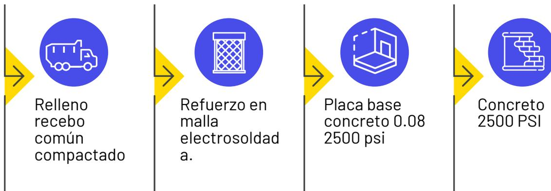
Placa de 8 cm en concreto de 2.500 psi, reforzada con malla electrosoldada de 4mm, soportada con una capa de relleno en recebo común compactado con espesor de 17 cm
