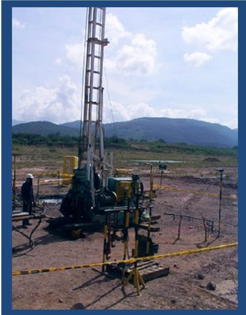
Equipos de perforación empleados en la perforación de pozos de gas en yacimientos de baja profundidad
