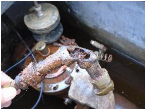
**Fotografía 36.** Válvula reguladora de nivel, Cámara de quiebre 1
